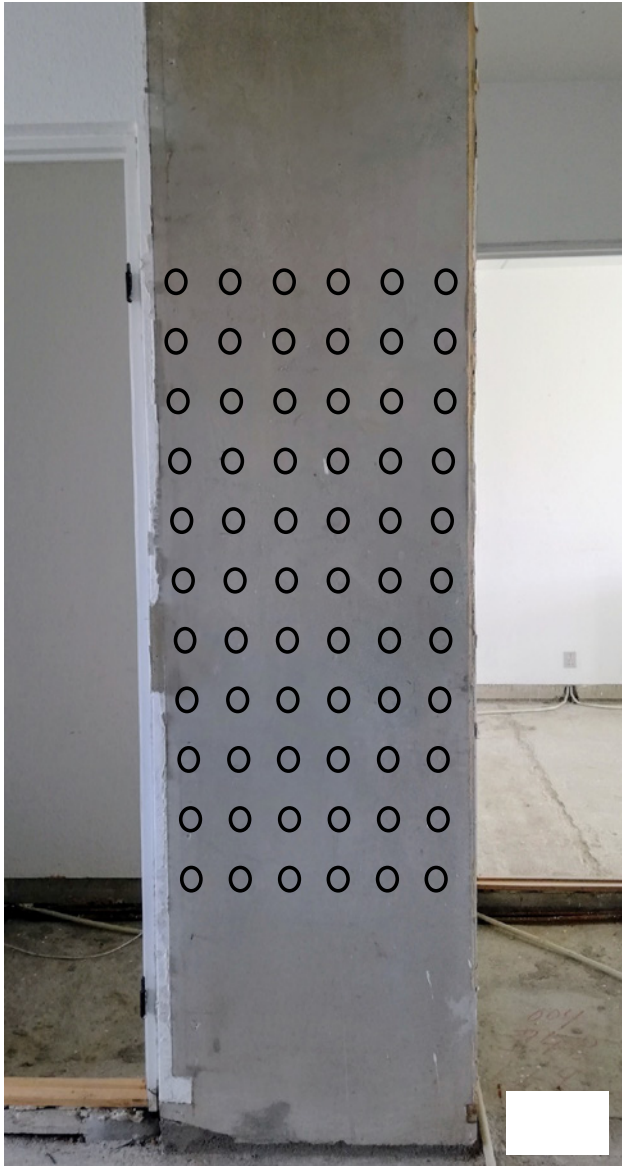
Fig. 9: Rumlig variansanalyse af et betonelement i Ringparken ved hjælp af RH-metoden: a: testlayout, b,c: sandsynlighedsfunktionen for RH-resultater (gennemsnit, standardafvigelse og fordelingsinterval er angivet)
