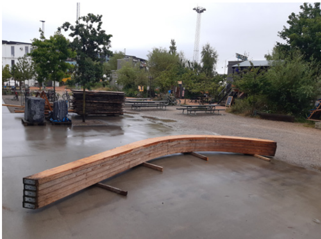
Fig. 4: Limtræsbeams fra P. Olesen Genbrug / Glulam beams from P. Olesen Genbrug
